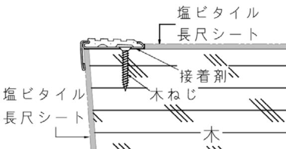
※両端約50mm(100mm以内)、中約300mmピッチ(2~3ヶ穴をとばす)で穴明して下さい。
